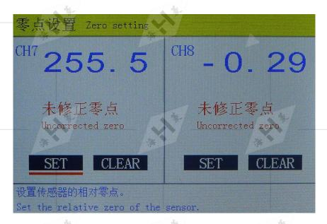
对于 CH7、CH8 两通道,本仪器可进行相对零点修正,"SET":设置当前测量值位置为相对零点; "CLEAR":清除相对零点设置。
